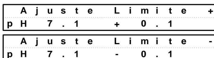
Figura 11 - Configuração dos Limites de Compensação do pH
