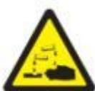
O líquido corrector do pH da água é corrosivo. Nos circuitos automáticos a bomba doseadora injecta esse líquido sob pressão na tubagem de circulação da água da piscina. Se aplicável, deve manusear-se este produto com cuidado.
