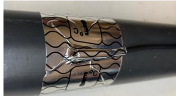
Figura 4 - Instalación de la sonda de temperatura
